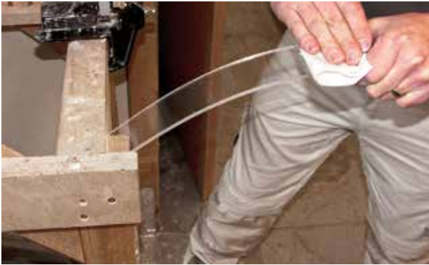
Schon dieser einfache Versuch in der Werkstatt verdeutlicht den Unterschied zwischen XT- und GS-Qualität: Ein Streifen XT-Plexiglas wird leicht gebogen und mit Verdünnung bestrichen.
