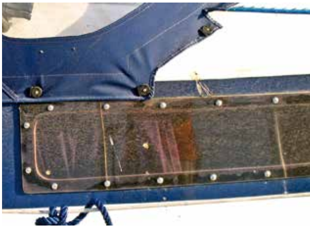
Klassisches Schadensbild. Der Kleber hat sich großflächig von der Scheibe gelöst, lange Risse deuten auf Fehler schon bei der Bearbeitung hin.
