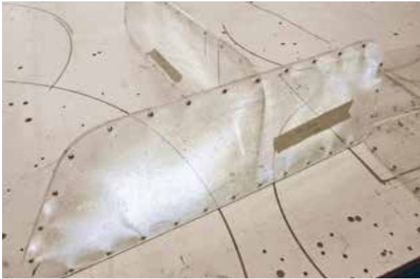
Folgen des Alters und falscher Pflege. Werden Plexiglas-scheiben mit falschen Reinigern behandelt, bilden sich in seiner Struktur feine Risse, die das Glas eintrüben.
