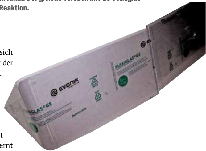
Nach der Herstellung wird beidseitig eine Schutzfolie angebracht, die auch die Qualitätskennzeichnung trägt, in diesem Fall GS. Die Folien sollten erst nach Abschluss der Bearbeitung abgezogen werden.
