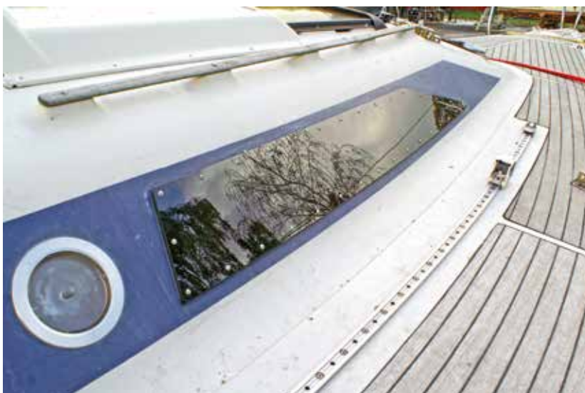
Neue Plexiglasfenster verjüngen eine Yacht nicht nur optisch, bei richtiger Materialwahl und Verarbeitung können sie auch über viele Jahre dicht halten.
