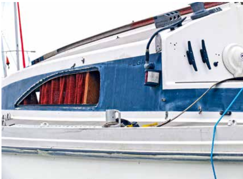
Neben den Klebeflächen der Scheibe muss auch der Untergrund, also der Aufbau oder der Rumpf, entsprechend vorbereitet werden. Auch hier wird gereinigt, gründlich entfettet und angeschliffen.
