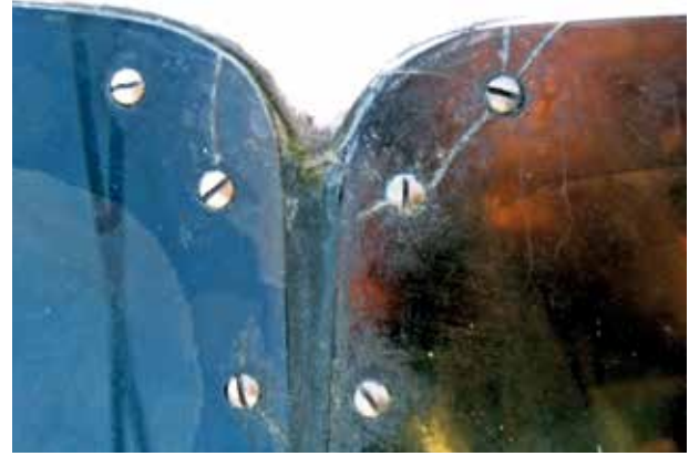
Senkkopfschrauben leiten nicht nur große Kräfte punktuell in das Material ein, sie nehmen der Scheibe auch die Möglichkeit zur Ausdehnung.
