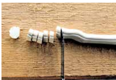
Distanzstücke aus demselben Material wie der verwendete Kleber sorgen für eine gleichbleibende Stärke der Klebefuge. Hierzu lässt man eine „Wurst“ Kleber aushärten und schneidet sie in gleichmäßige Scheiben.
