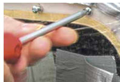
Fest, aber nicht zu fest. Die Schrauben werden wechselweise nur so stark angezogen, dass sich überall eine gleichmäßige Klebefuge ergibt. Mehr Druck verformt nur das Material und drückt den Kleber heraus.
