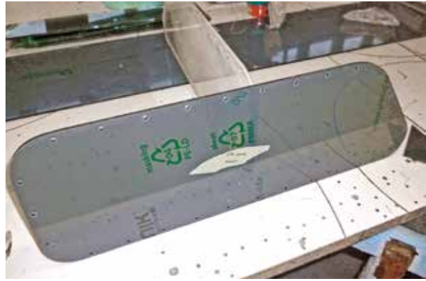
Plexiglas ist in vielen Farben erhältlich, eine dunkle Tönung kann nicht nur optisch interessant sein, sie schützt auch die Verklebung besser vor schädlicher UV-Strahlung.
