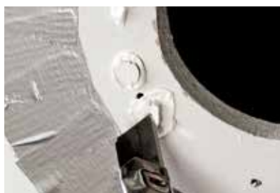
Die Distanzstücke werden entweder wie hier auf den Aufbau geklebt oder ausgebohrt und wie Unterlegscheiben auf die Schrauben gesteckt. Dies ist bei gebogenen Scheiben besonders wichtig.
